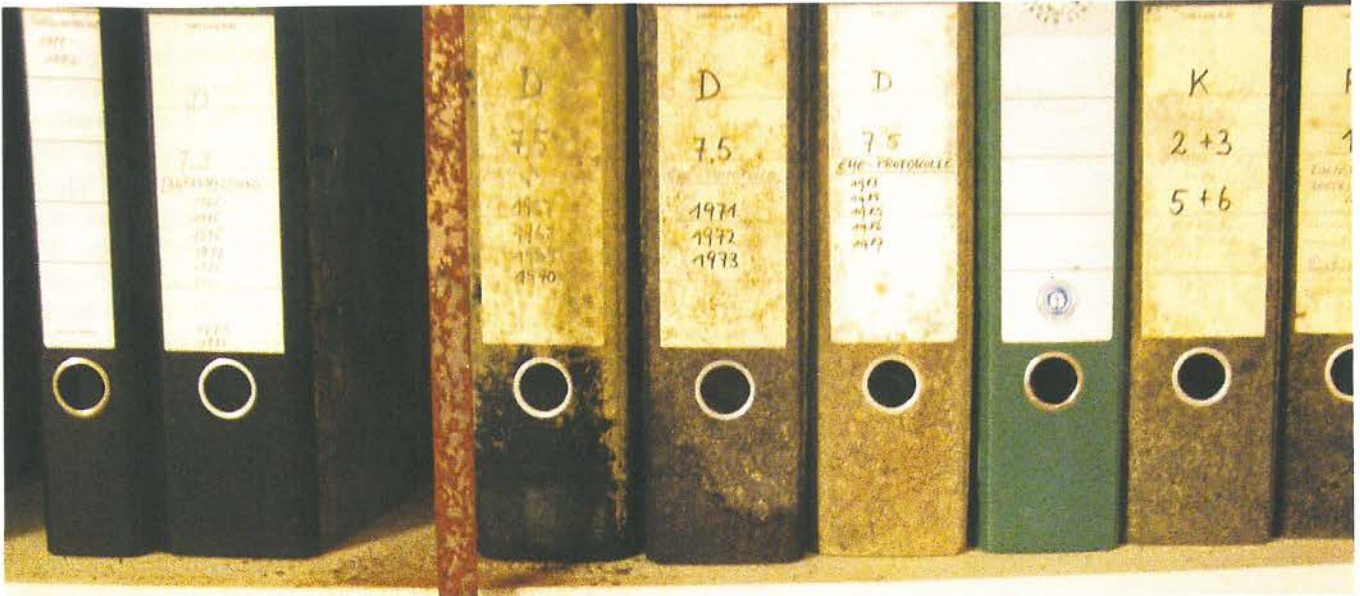
Muggsoppinnserte arkivalier må grovrensnes først, før de kan flyttes til en rengjøringsstasjon eller muggsluse for grundig sanering. Bilde: SCHEMPPE BESTANDSERHALTUNGS GMBH.
